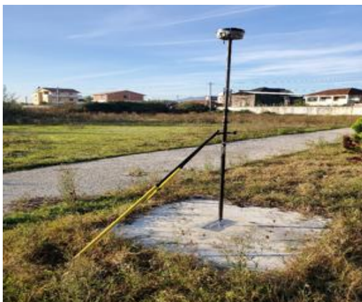
Figure 2: GNSS Sokkia GRX2
